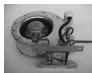
Gebläse 230 V, AC, mit eingebaute Gebläseklappe, Baujahr von 1999 bis ca. Mitte 2000
