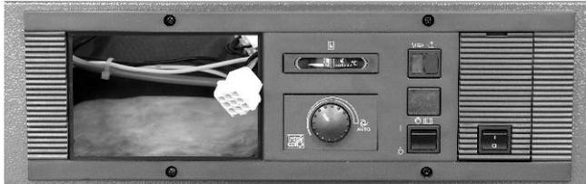
Abb. 22 Steckverbinder aus dem Ausschnitt ziehen
