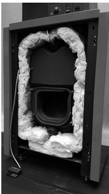
7.) Den oberen Deckel und die Seitenwand wieder montieren.
