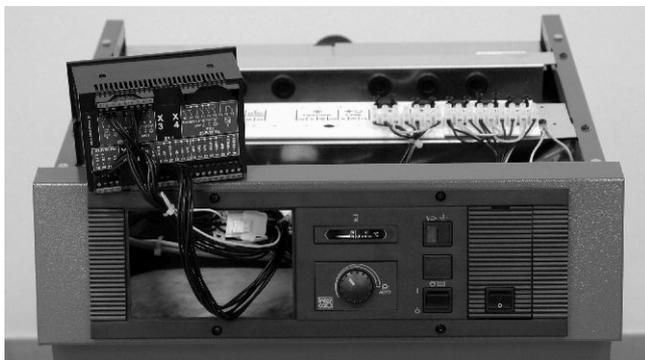
Abb. 23 Reglerkabelsatz in den Steckverbinder stecken, Anschlussklemmen am Regler aufkleben und Anschlussklemmenwinkel auf der Traverse einklipsen.
