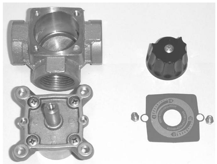
Abb. 9: Der Heizungsmischer zerlegt
