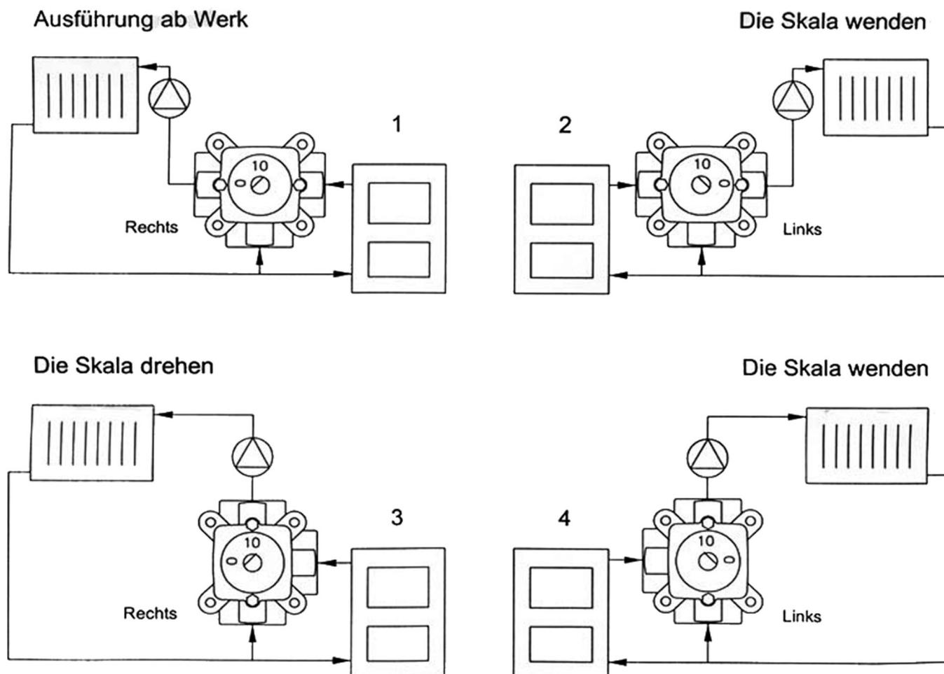
Abb. 11-1 bis 11-4: mögliche Einbaulagen
