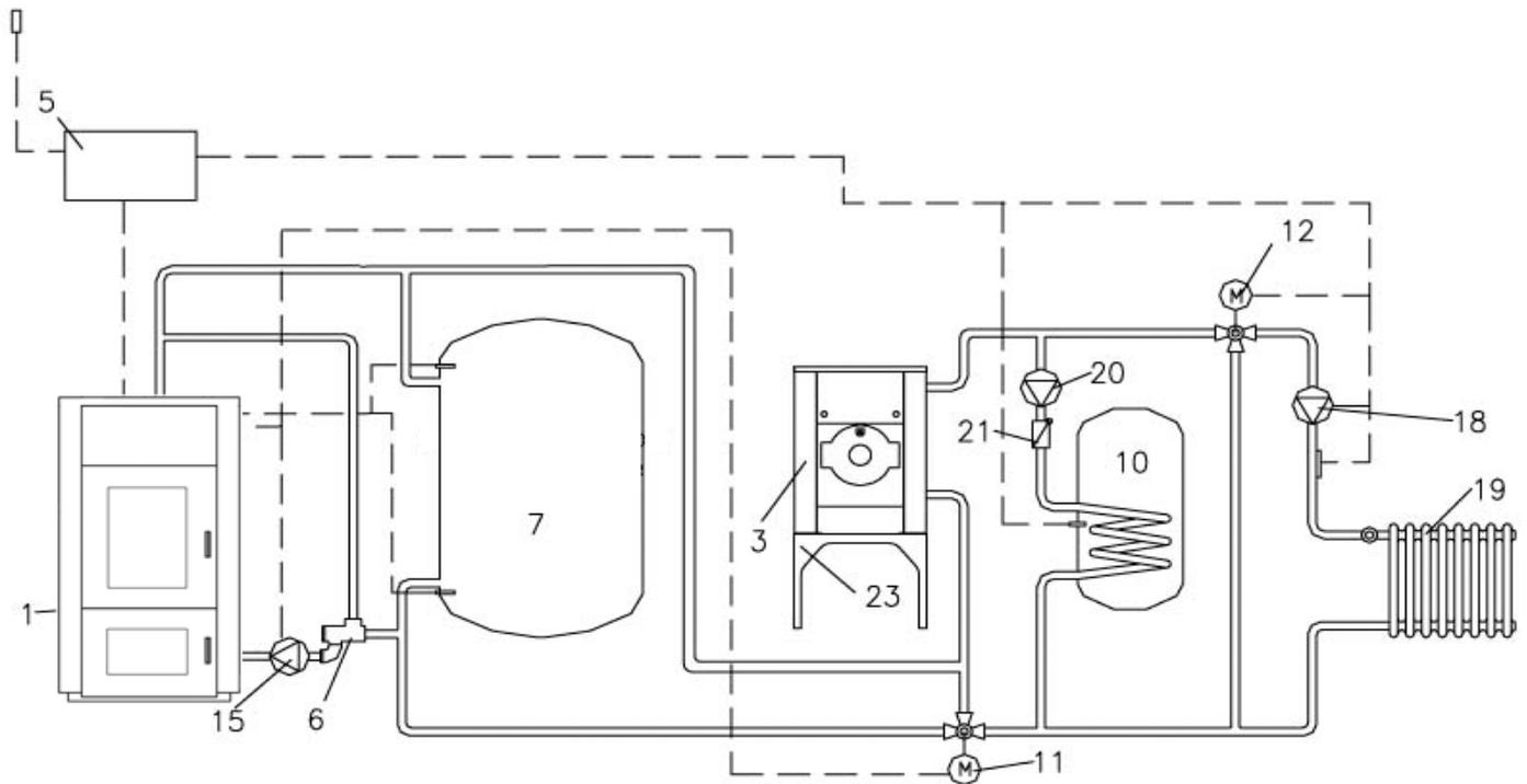
Abb. 44: Hydraulikschema nach Anlagenkombination S11
