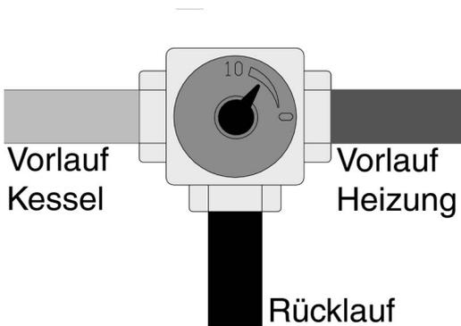
Abb. 7: Der Mischer in einer Zwischenstellung
