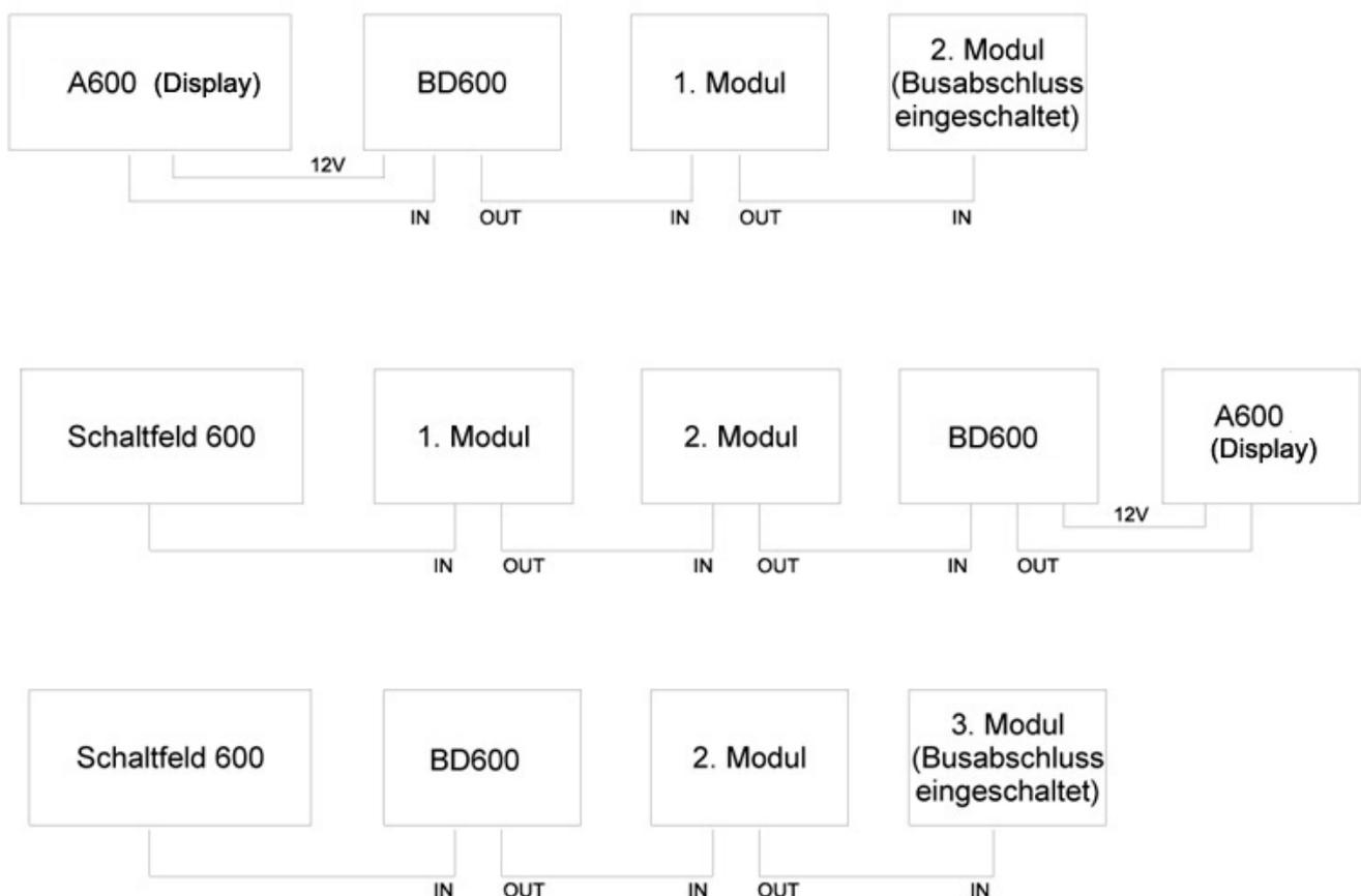
Abbildung 2: Prinzip der Modulkopplung
