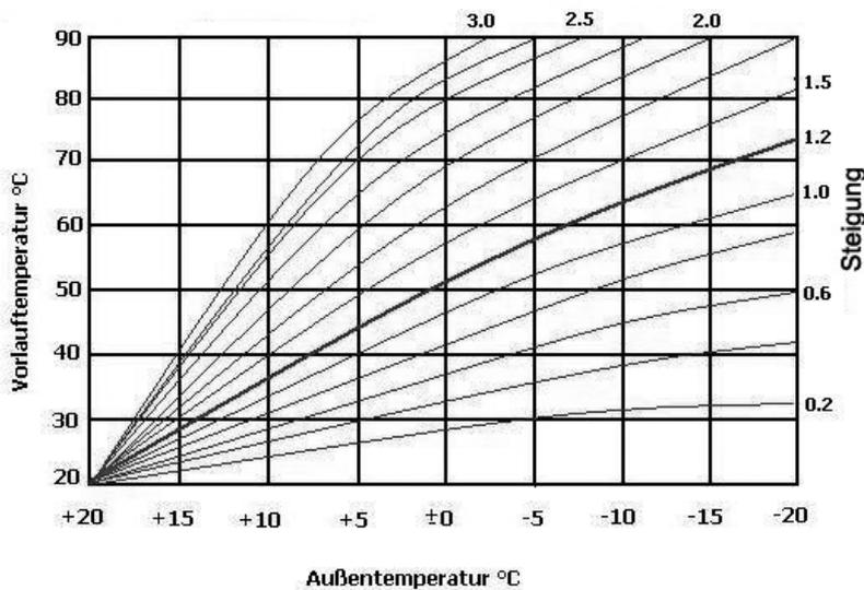
Abbildung 14: Heizkurve, Heizkennlinie
