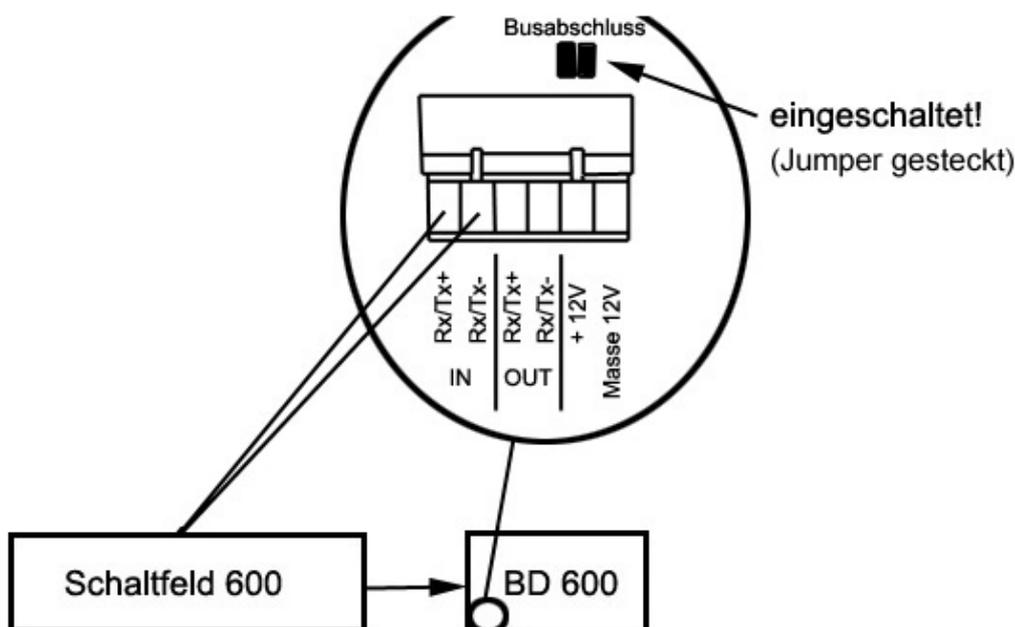
Abbildung 4: Kopplung von Schaltfeld und Außentemperatursteuerung BD600
