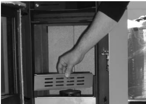
Abb. 23b: Herausziehen der beiden Vorstellroste
