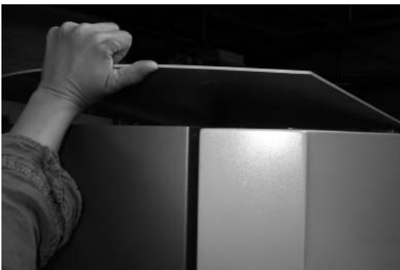
Abb. 36/37: Abnehmen der oberen Verkleidungsdeckel (vorn und hinten)
