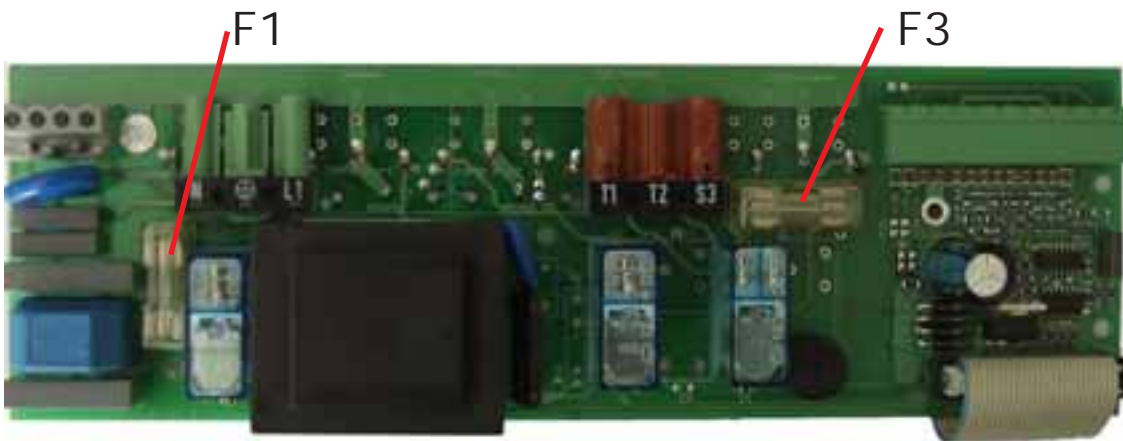
Abb.9-1: Lage der Sicherungen F2 und F3
